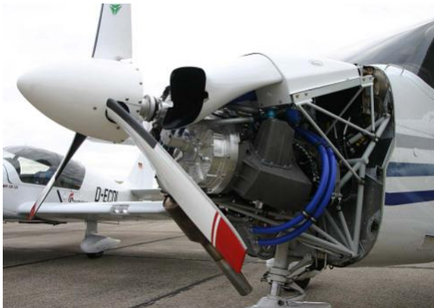
Cessna 172, som konverterats till dieseldrift med en Thielert motor.
