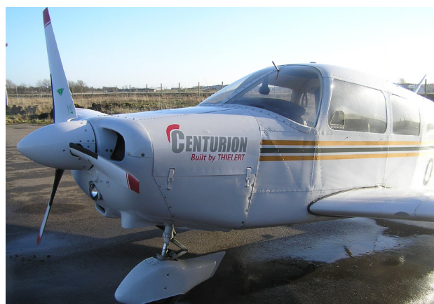
Piper PA-28 Warrior, OY-TAE, fd SE-GIE med TAE dieselmotor på 135 hp och trebladig propeller.
