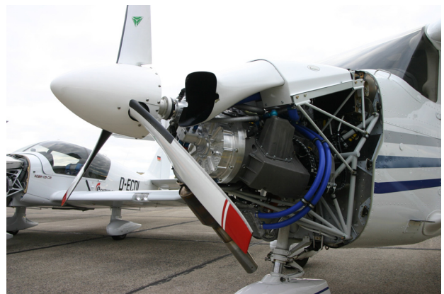
TAE Centurion 2.0 i en Cessna 172. Propellerväxeln syns bakom propellern.
