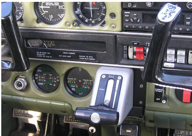
Vid konvertering till dieselmotor blir det en del förändringar i cockpit. Bl.a. nya motorinstrument och ny reglage för inställning av motoreffekt. Kostnaden för konvertering till TAE Centurion 2.0 är ca 38 000 EUR, men driftkostnaderna blir ca 50-60% lägre.
