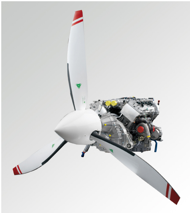
TAE dieselmotor Centurion 2.0 med propellerväxel med alla tillbehör väger 150 kg. Den 3-bladiga propellern bidrar till mindre vibrationer och lägre buller.
