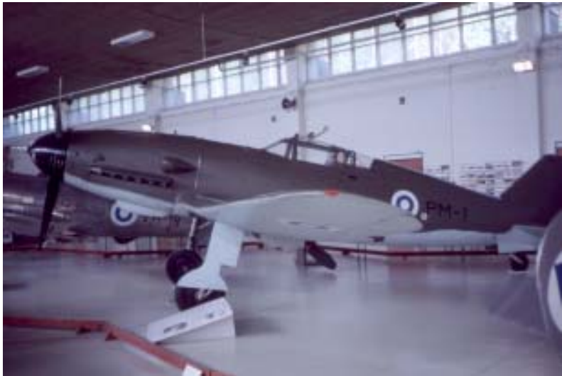
Finskybyggd variant av Messerschmitt Bf-109 i trä. Flygplanet kallades för Pyörremyrsky och finns på museet. Foto: Nils-Arne Nilsson/SFF arkiv.
