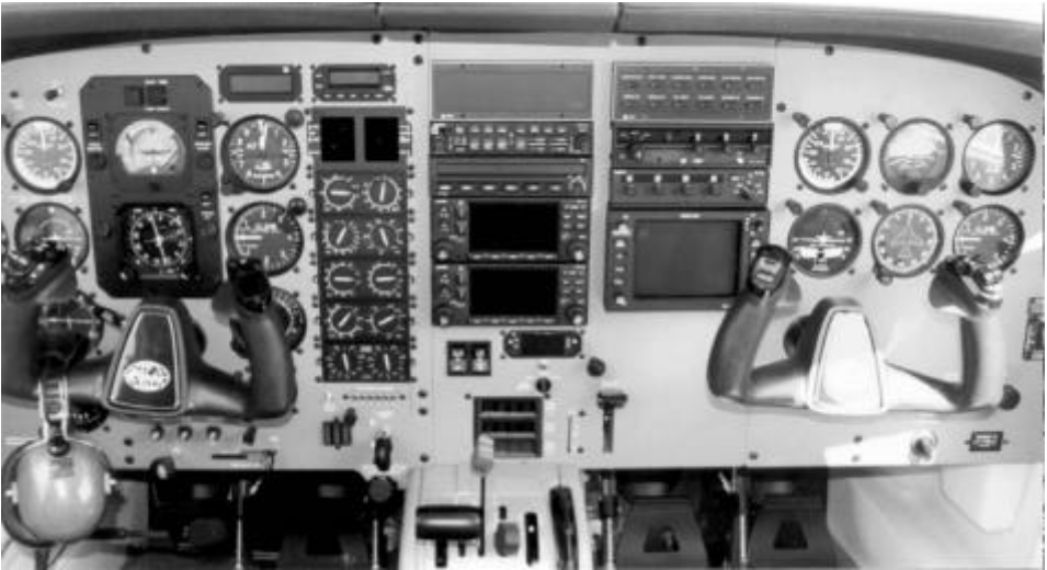
Instrumentpanelen i SE-11P. I utrustningen ingår slavat gyro, S-TEC autopilot, dubbla Garmin GPS (GNS430), väderradar, stormskop, radarhöjdmätare och avisning
