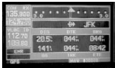
20,5 NM kvar till JFK VOR med en ground-speed på 141 kt, dvs medvind.
